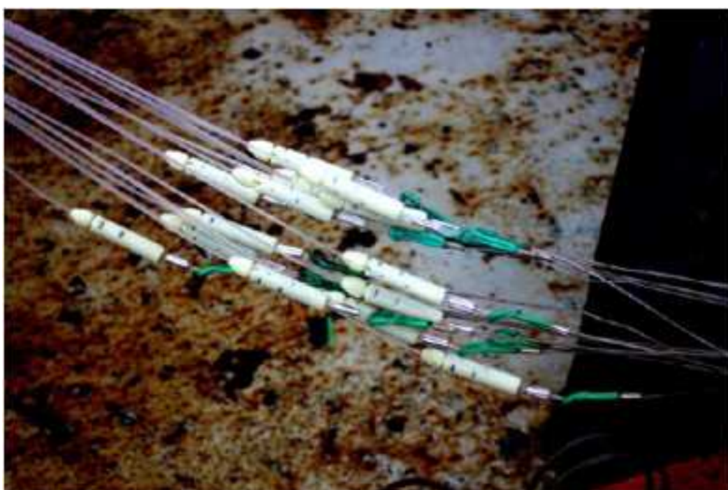
Figura 1: Trecho da linha secundária do espinhel com os lumo leads de 60 g utilizados no experimento.
